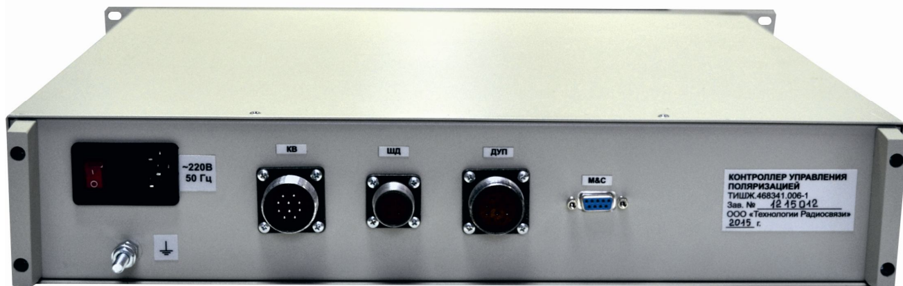
Рисунок 1.2.2.4.1 – Внешний вид КУП со стороны лицевой и задней панелей Основные технические характеристики (параметры) КУП приведены в таблице 1.2.2.4.1.
