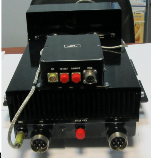
Рисунок 1.2.4.1 – Внешний вид конвертора БПР0917-1314/100Д
