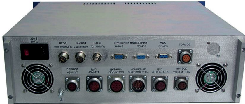
Рисунок 1.2.2.1.2 - Внешний вид задней панели БУА 3700
